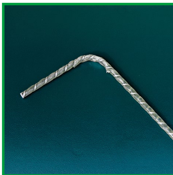
Connettore a L in GFRP della ditta GAVAZZI tipo CONR-E07 ad aderenza migliorata
